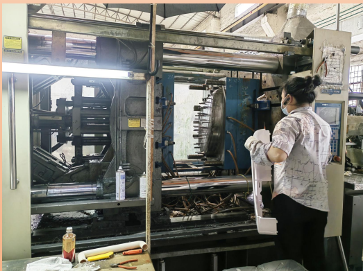
用大功率注塑机，快速成型复杂的塑胶模型，出品高效
